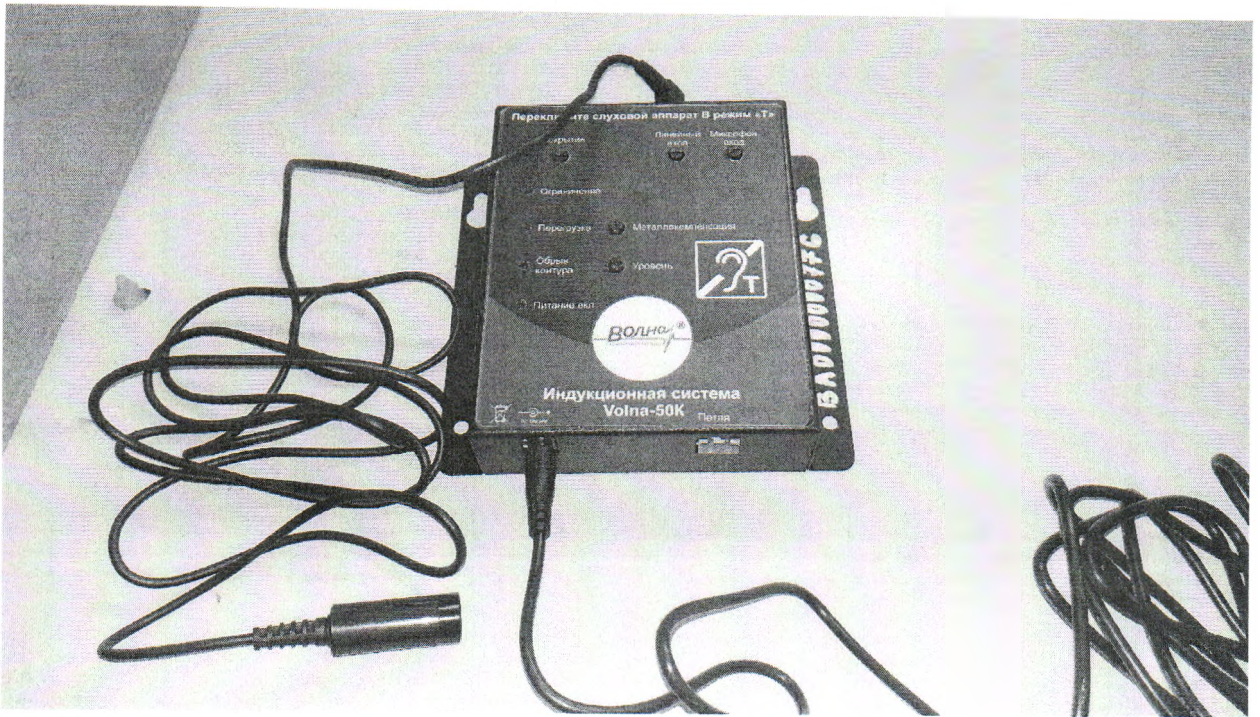
Рисунок 43. Индукционная система Volna-50K стационарная для слабослышащих, установлена в актовом зале
